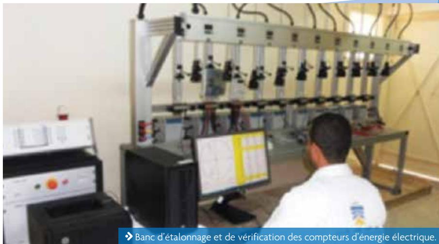
➤ Banc d'étalonnage et de vérification des compteurs d'énergie électrique.
